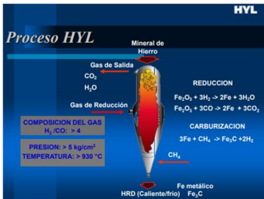
Figura 11. Esquemática del Proceso de reducción directa HYL
