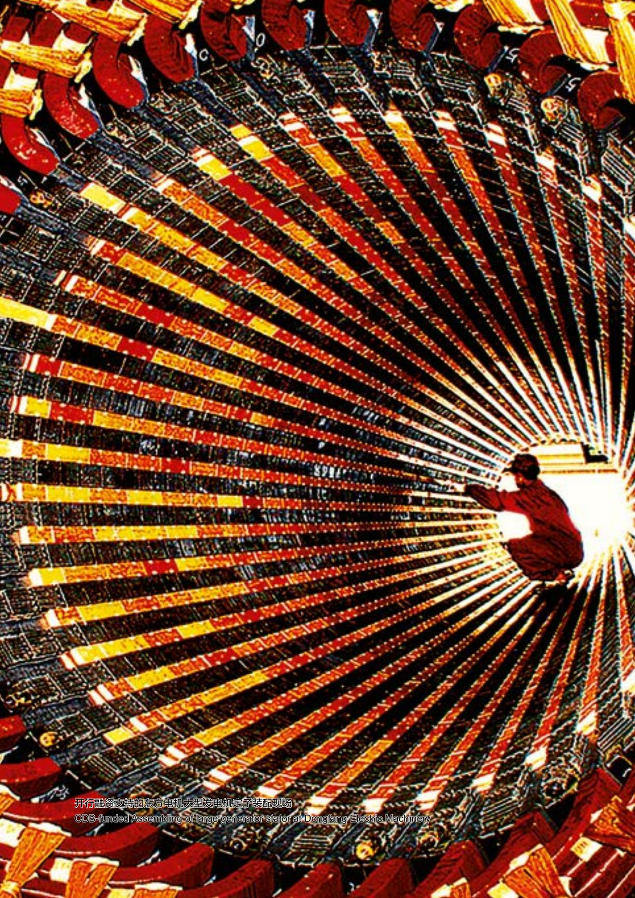
开行融资支持的东方电机大型发电机定子装配现场
